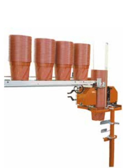
Pneumatisches Topf- magazin mit PLC-Steuerung
