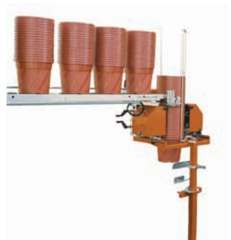
Pneumatisches Topfmagazin mit PLC-Steuerung
