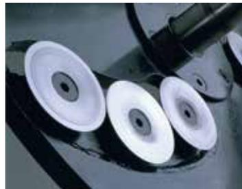
Le système 'Disque-Lame' grâce à son action tranchante plutôt que frappante est moins bruyant de 1,5dB selon des données indépendantes fiables. Il est important de noter qu'une réduction de 3dB est l'équivalent d'une diminution de moitié de l'intensité du bruit.
