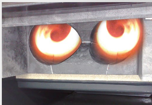
Höchste Effizienz durch einzigartige Doppelwirbelbrennkammer aus SiC (kein Schamott)
