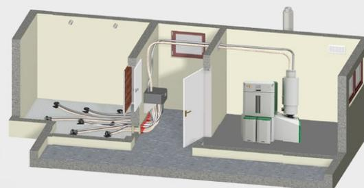
Abbildung: Saugbehälter DIRECT in Kombination mit 8-Punktabsaugung
