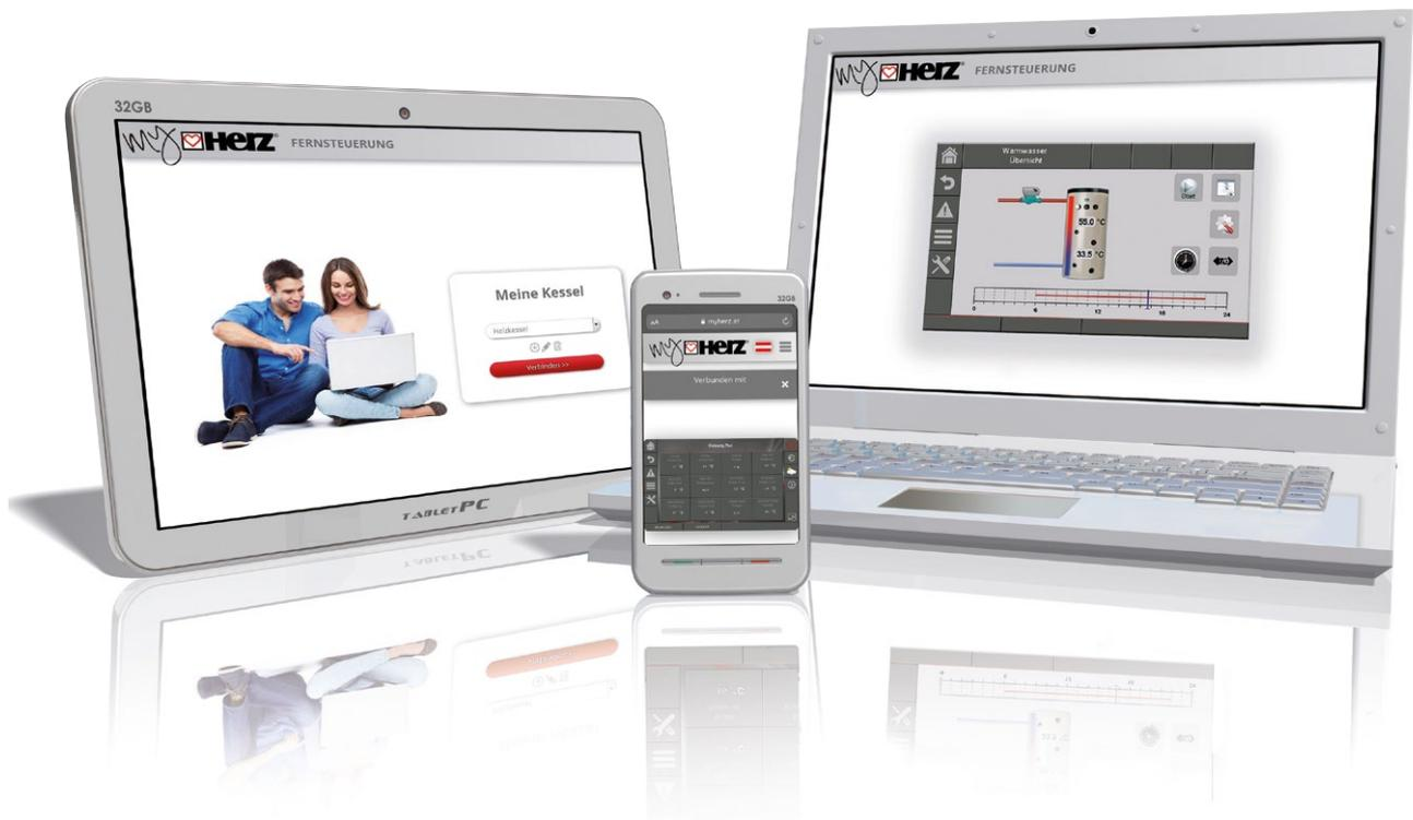
Mit der bedienerfreundlichen Farb-Touch-Display-Regelung T-Control können neben der Verbrennungsregelung auch Heizkreise, Boiler, Puffer und Solar angesteuert werden.
